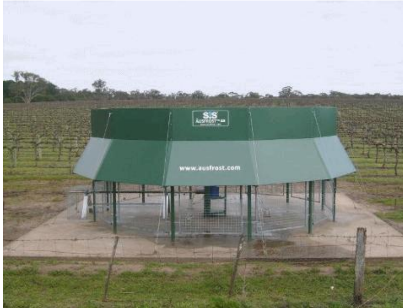
25. ábra: Fügőleges áramú légkeverő ventilátorok
