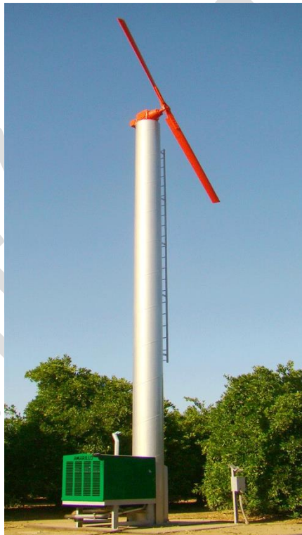
23. ábra: Vízszintes áramú légkeverő gép (szélgép) Forrás: www.agrofrost.eu ; www.ghentsupply.com
