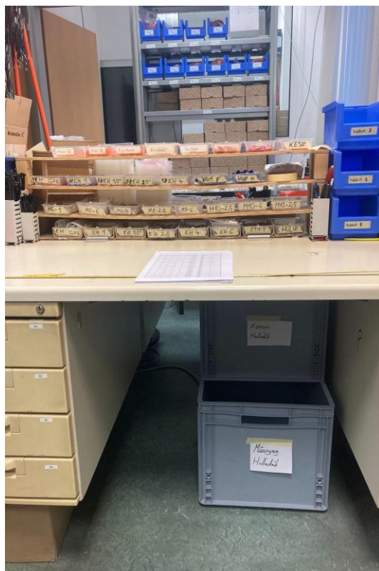
Ábra 8 5s utáni kábelező asztal, forrás: Saját készítés
