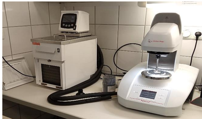
4. ábra: Anton Paar MCR 92 rotációs és oszcillációs viszkoziméter (saját kép)
