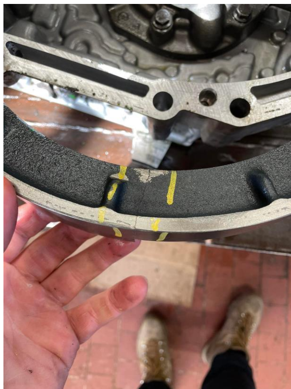
38. ábra: A repedt dugattyú
