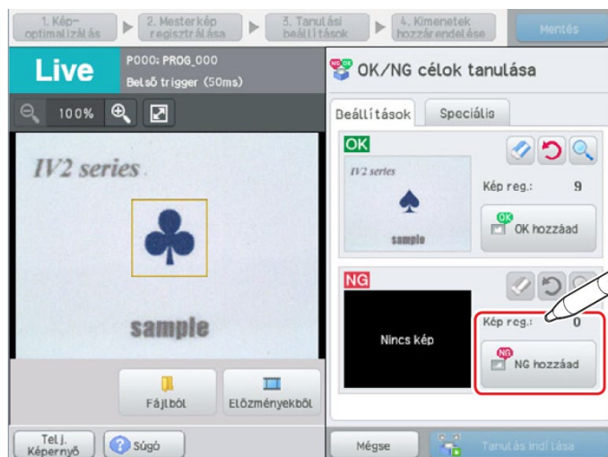
37. ábra: A mesterkép beállítása: OK - NG kép hozzáadása [22]
