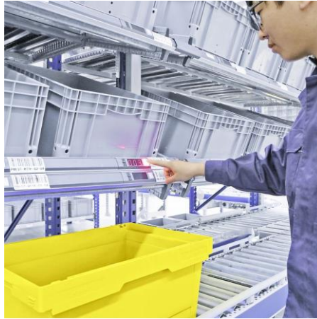
11. ábra Pick-by-light rendszer
