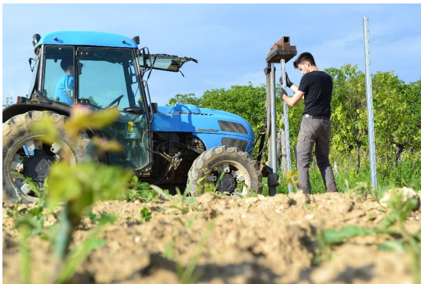
5. ábra: Fém soroszlop elhelyezése
