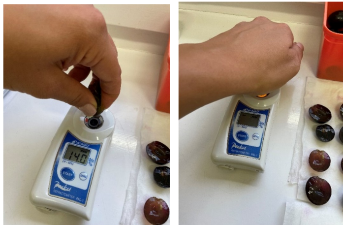
7.ábra Atago Refractometer Pal-1 (Fotó: Körtvélyesi 2023)
