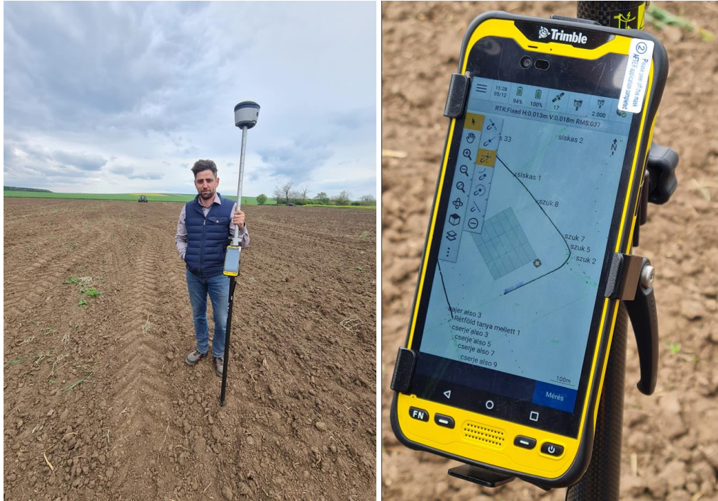
16. ábra: A Trimble TDC 600-as nagy pontosságú helymeghatározó
