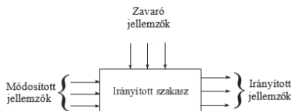
3. ábra: Irányított szakasz jellemzői (Nemes, 2012)
