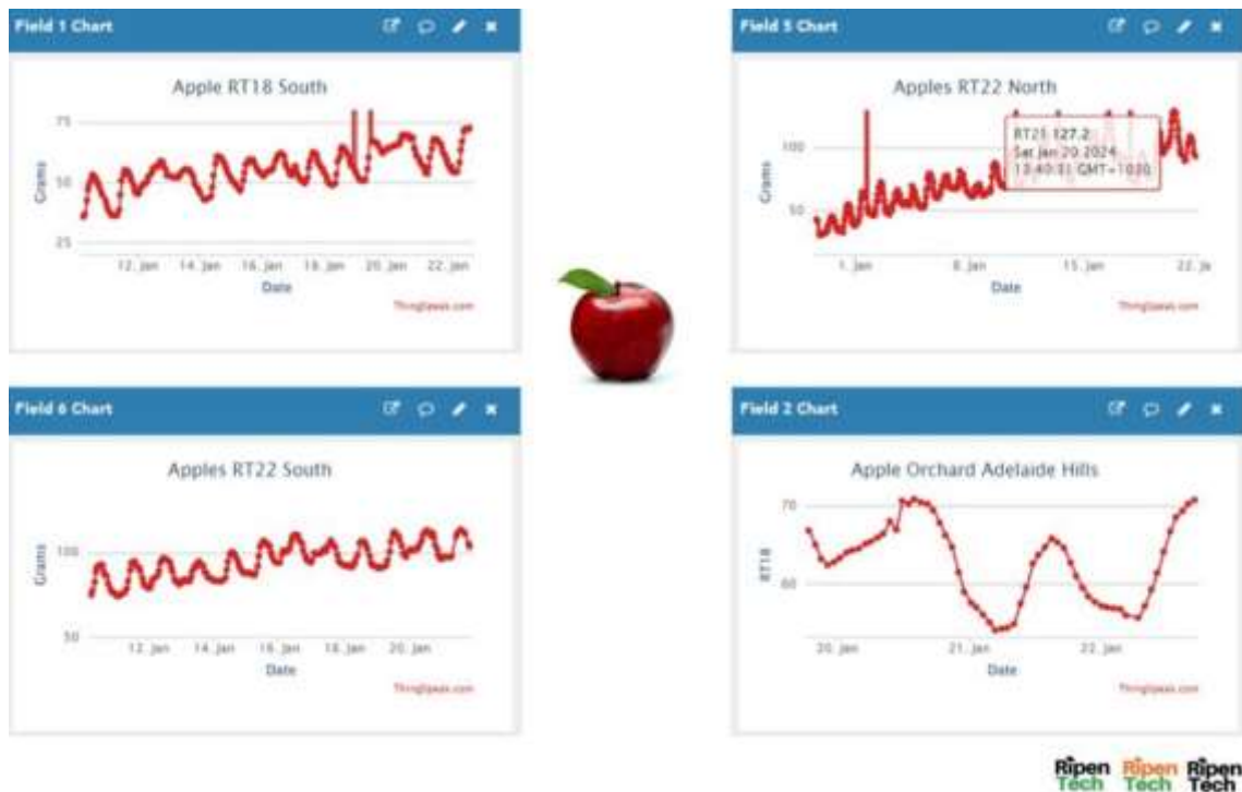
14. ábra Valós idejű almatömeg mérések a Thingspeak alkalmazáson keresztül.
