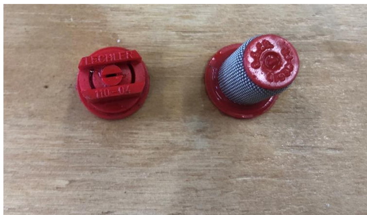
11.ábra: 110-04 LECHLER fúvóka és a benne lévő szűrő (2024.02.27)
