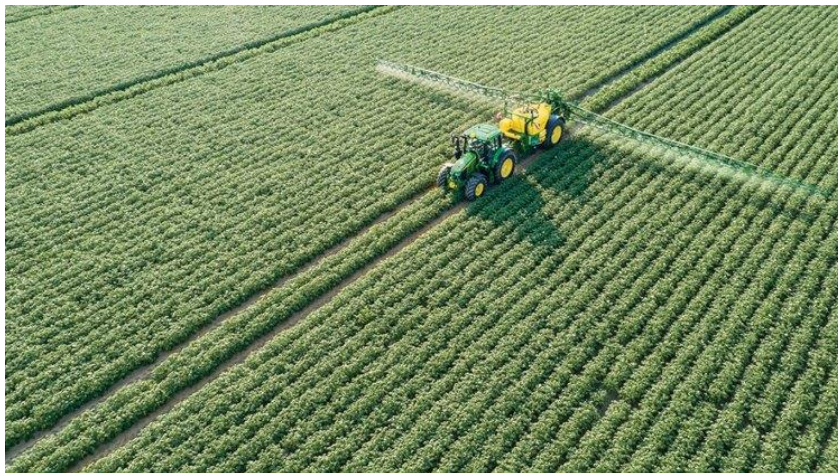
10.ábra. Vontatott kivitelű szántóföldi permetezőgép művelőnyomban, munka közben (INTERNET 11)
