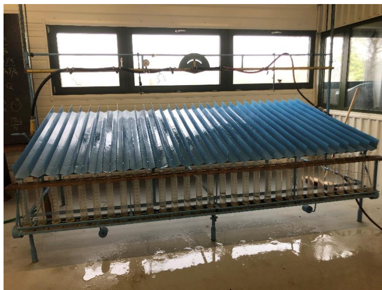
12.ábra. Keresztirányú szórás egyenlőség mérése mérőpadon (2024.02.27)
