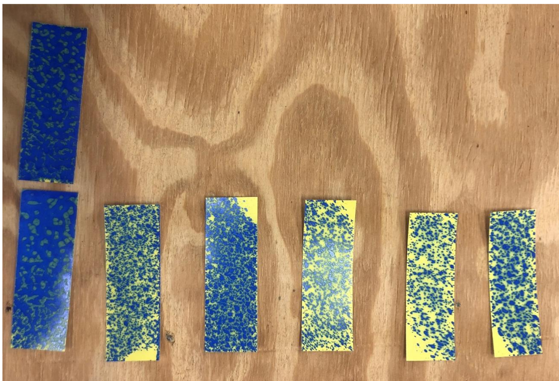
21.ábra. Víz érzékeny papír balról kezdve 4 bar; 3,5 bar; 3 bar; 2,5 bar; 2 bar 1,5 bar (2024.02.27)
