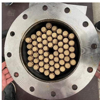
23. ábra A hőtároló tartály a töltet tároló csövekkel terelőlemezekkel
