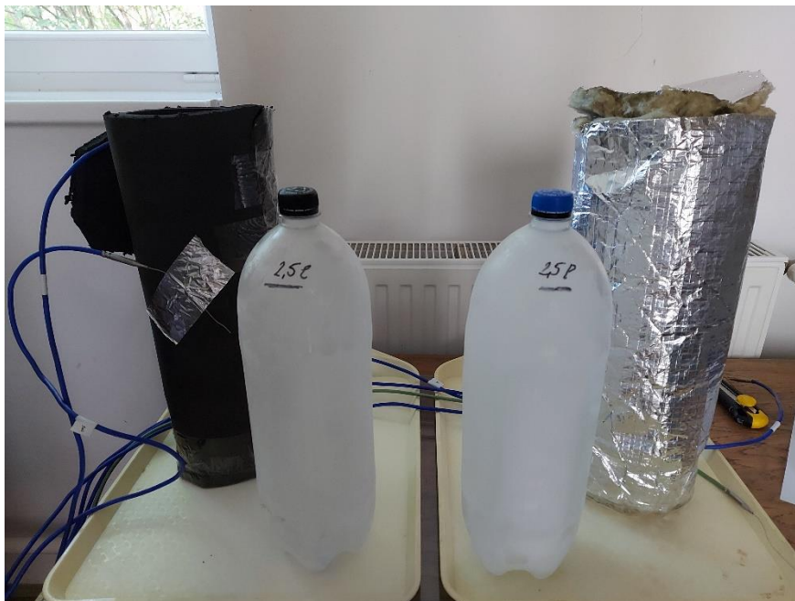
30. ábra Palackok tele jéggel és hőszigetelő burkok hőszenzorokkal
