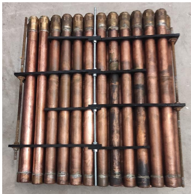
43. ábra: Töltet tároló csövek és terelőlemezek összeszerelve Forrás: Saját ábra
