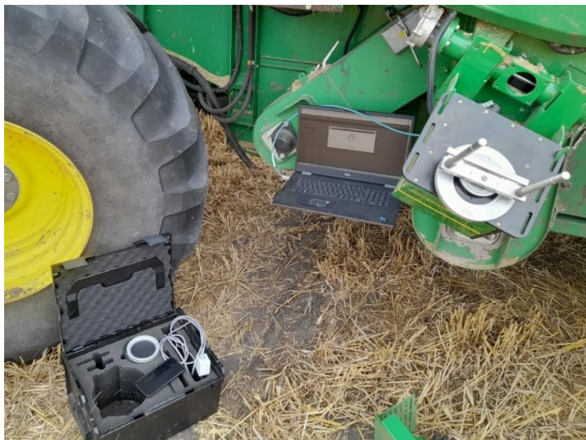
36.ábra: Grain Sensing rendszer telepítése – S770 magfelhordóra (forrás: saját fotó)
