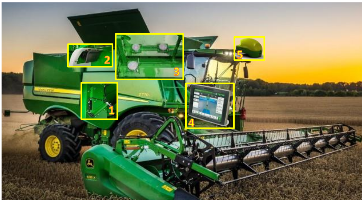
33.ábra: Aktív hozammérő rendszer felépítése (forrás: saját szerkesztés - deere.com)
