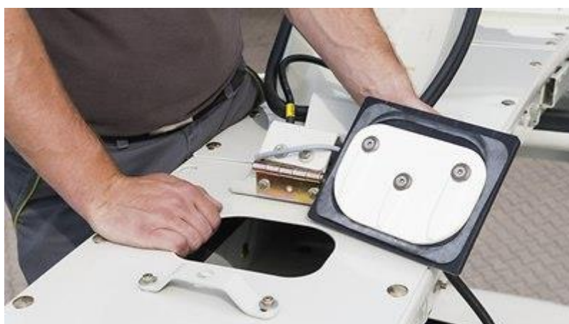
17.ábra: Silózógép Szárazanyag tartalom szenzor elhelyezése (Jaguár 800; forrás: claas.hu)
