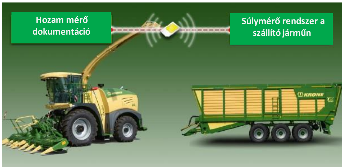
34.ábra: AutoCalibrate automatikus kalibrációs mérleg rendszer (Krone, forrás: tulloch.nz)
