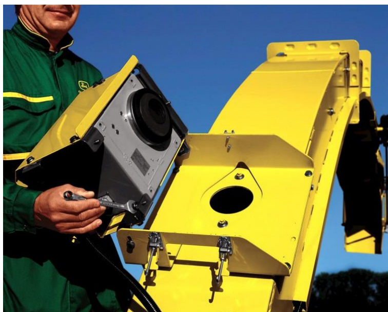
16.ábra: Az önjáró szecskázó NIR szenzor elhelyezése (HarvestLab3000; forrás: kite.hu)
