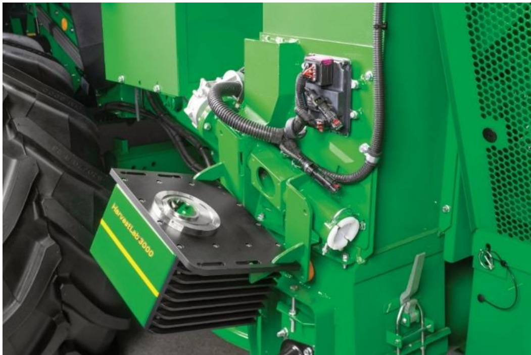
13.ábra: Nedvesség és beltartalmi minőségszenzor elhelyezése a magfelhordó alsó részén (John Deere S770 kombájn, forrás: deere.com, 2022)
