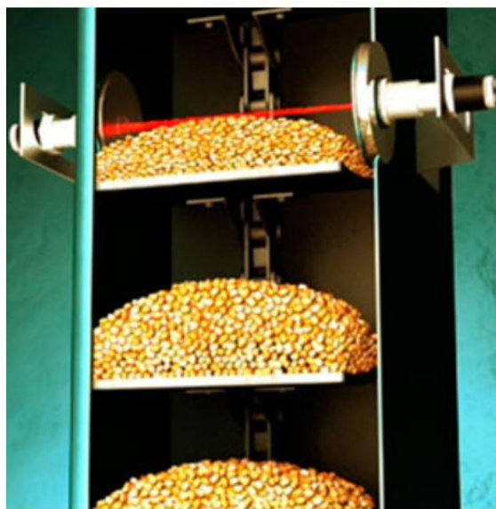
19.ábra: Optikai hozammérő szenzor felépítése (forrás: Trimble hozammérő; axial.hu)
