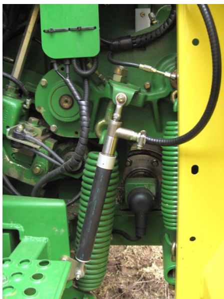
15.ábra: Az önjáró szecskázó hozammérő szenzor elhelyezése (forrás: Hajmásy Gy., 2019)
