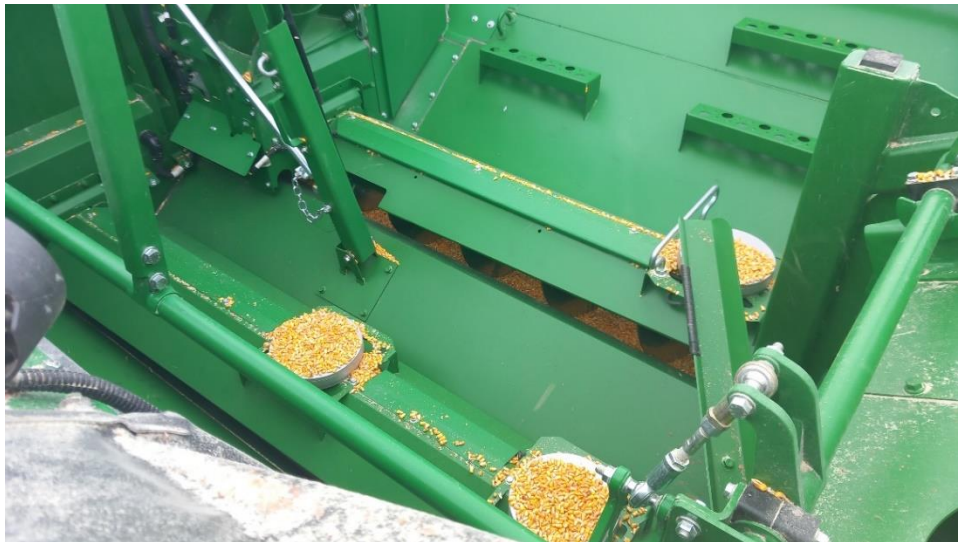
29.ábra: Az aktív mérőcellák (3db) elhelyezése a magtartályban (forrás: saját fotó)
