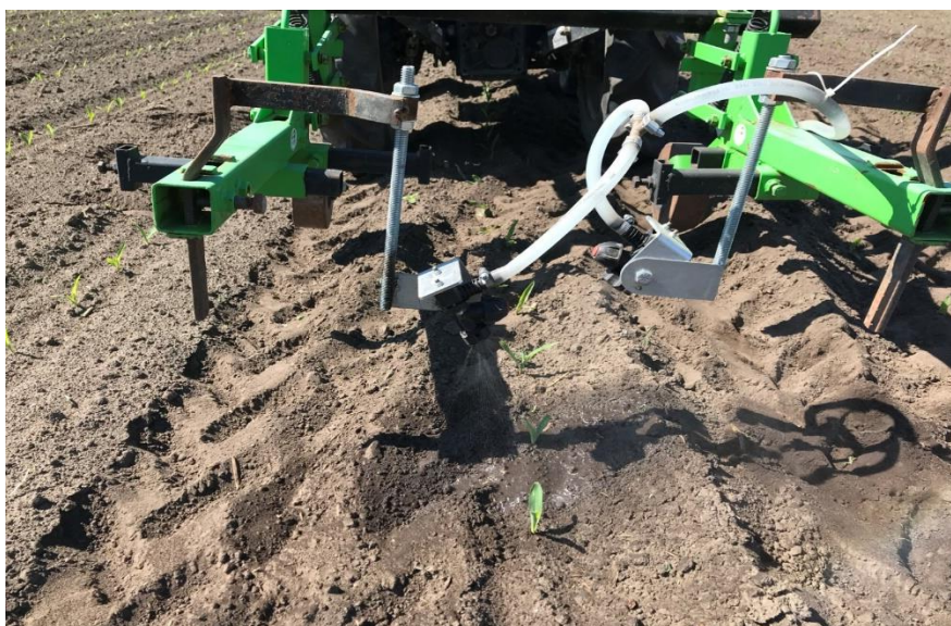
15. ábra: az egyedi, kultivátorra szerelt sávpermetező eszköz (saját)
