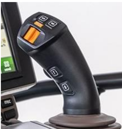
21. ábra John Deere elektronikus joystick kéz érzékelő funkcióval; JD New 6R advanced training
