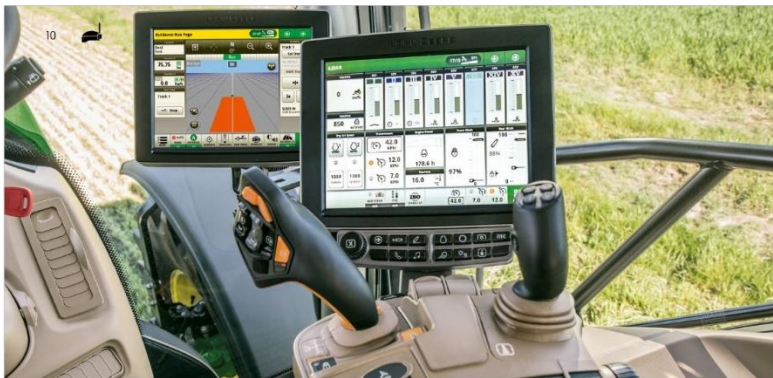
20. ábra John Deere traktor CommandArm könyöktámasszal joystick kezelőelemekkel is kettős kijelzővel; JD 6R traktor áttekintés CSP-34-SE2AL006
