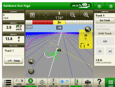
23. ábra Autotrac Turn Automation - automatikus táblavégi forduló (Mészáros 2022)
