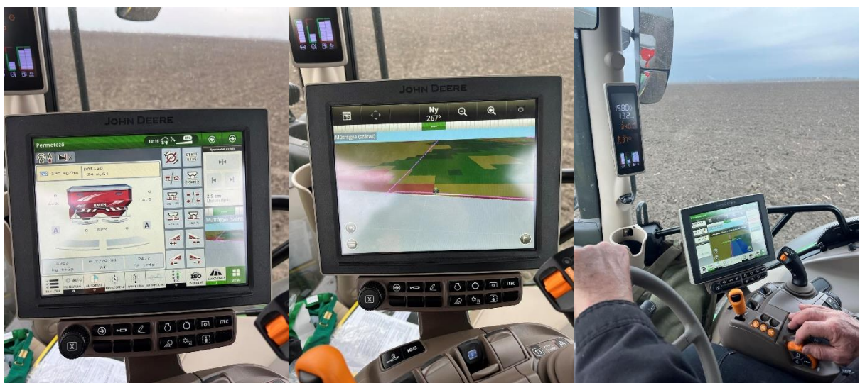
18. ábra. A műtrágyaszóró beállításai, illetve a monitoron megjelenő kijuttatási térkép
