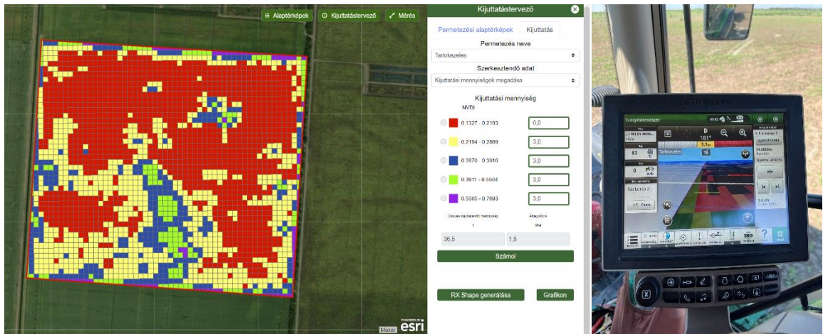
24. ábra. A kijuttatási térkép a gyomirtószer mennyiségének meghatározásával, illetve ugyanez a térkép a traktor képernyőjén megjelenítve
