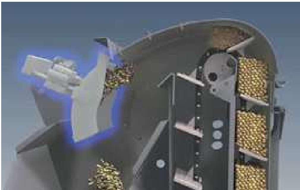
2. ábra: Ütközőlapos termény tömegáram szenzor (forrás: New Holland CR Revelation kombájnok termékismertető, 2020)
