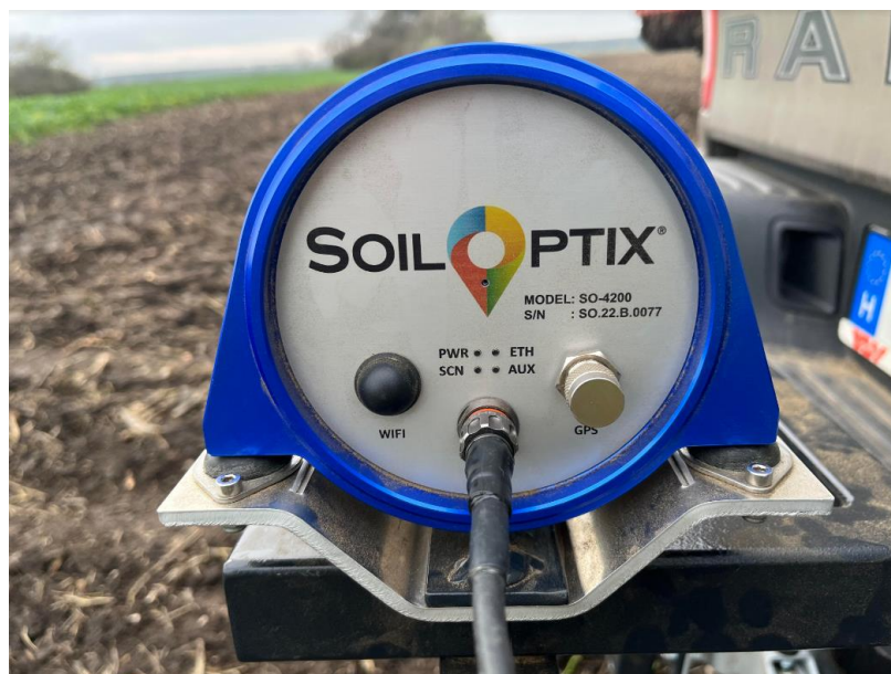
1. ábra: SoilOptix® szenzor (Forrás: Saját fotó)
