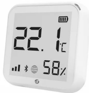
4.10. ábra: Shelly Plus H&T okos hőmérséklet és páratartalommérő szenzor (saját szerkesztés)
