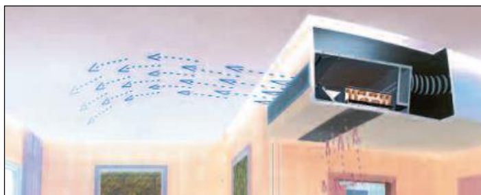
24.ábra: Indukciós befűvő az álmennyezetben
