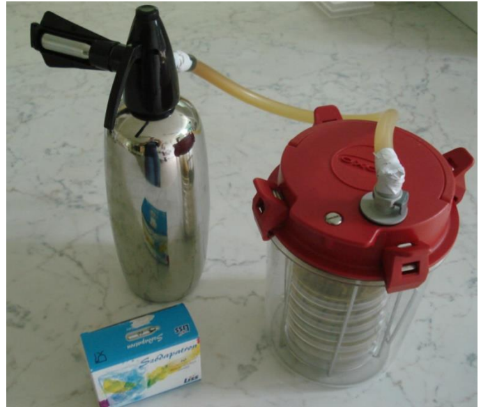
2. ábra A tejsavbaktériumok széndioxiddal dúsított légtérben történő tenyésztésének megvalósítására alkalmazott „berendezés”.
