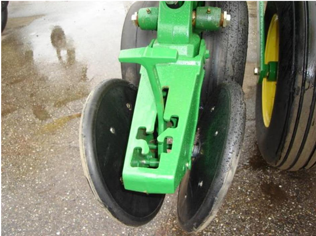
7. ábra: V tömörítő kerék, a tömörítés négy fokozatban állítható, [saját fotó]
