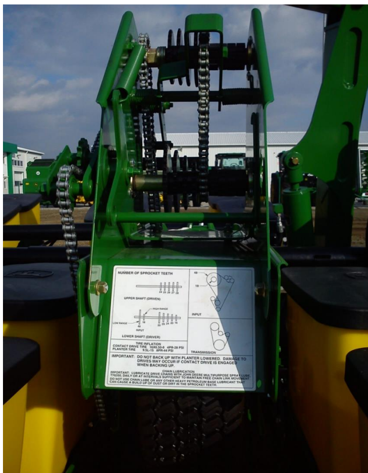
8. ábra: Váltómű lánchajtással az áttételi arányokkal [Saját fotó]
