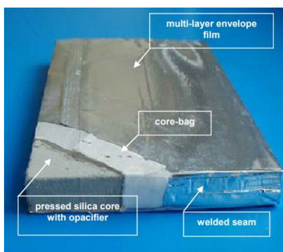
8. ábra: Vákuumpanel felépítése (EMPA et al., 2005)
