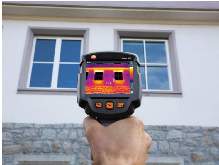
9. ábra Testo 872 Hőkamera [16]
