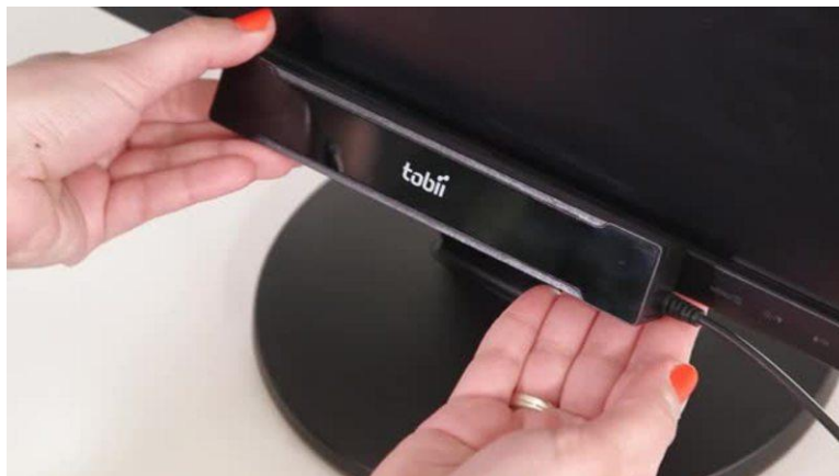
7. ábra Tobii Pro X2 szemkamera (Forrás: Internet 2.)
