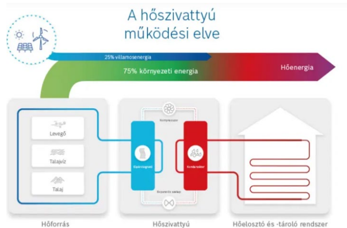
4. ábra Levegő - víz hőszivattyú felépítése (bosch.com)
