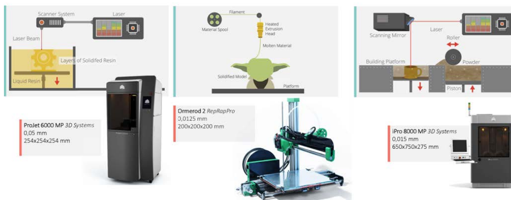
12. ábra Példák additív gyártási eljárásokra, forrás: Zsidai L., Mózes A. (2023)
