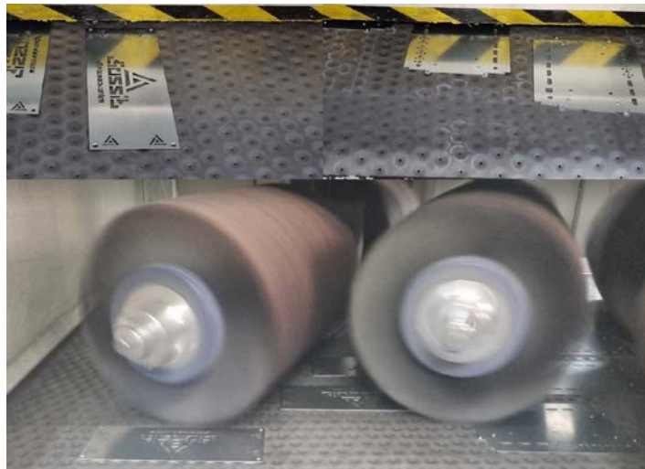
82. ábra Gépi sorjázás fotók, forrás: saját kép
