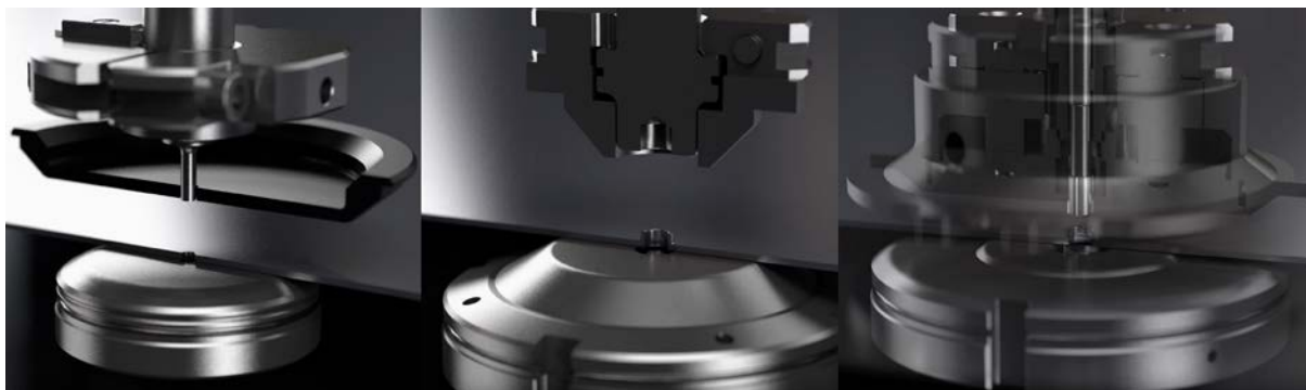
73. ábra Szemhúzott menet formázása, forrás: Trumpf GmbH
