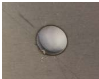
63. ábra Körök kivágásánál megjelenő orr, forrás: saját kép
