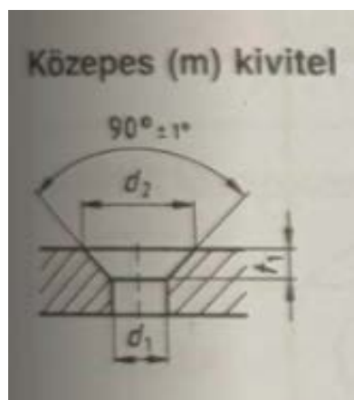
31. ábra DIN 74, forrás: Frischherz- Kotsch- Itchner- Gundelfinger- Haffner- Dax (1997)
