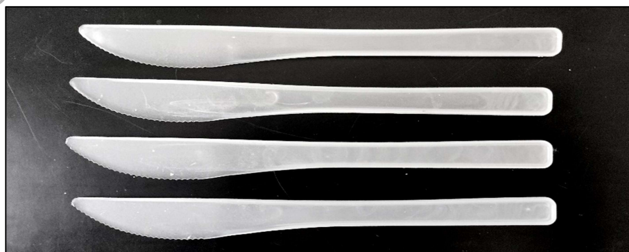
4. ábra: Keményítő tartalmú politejsav biokompozit evőeszköz (Forrás: saját fotó)
