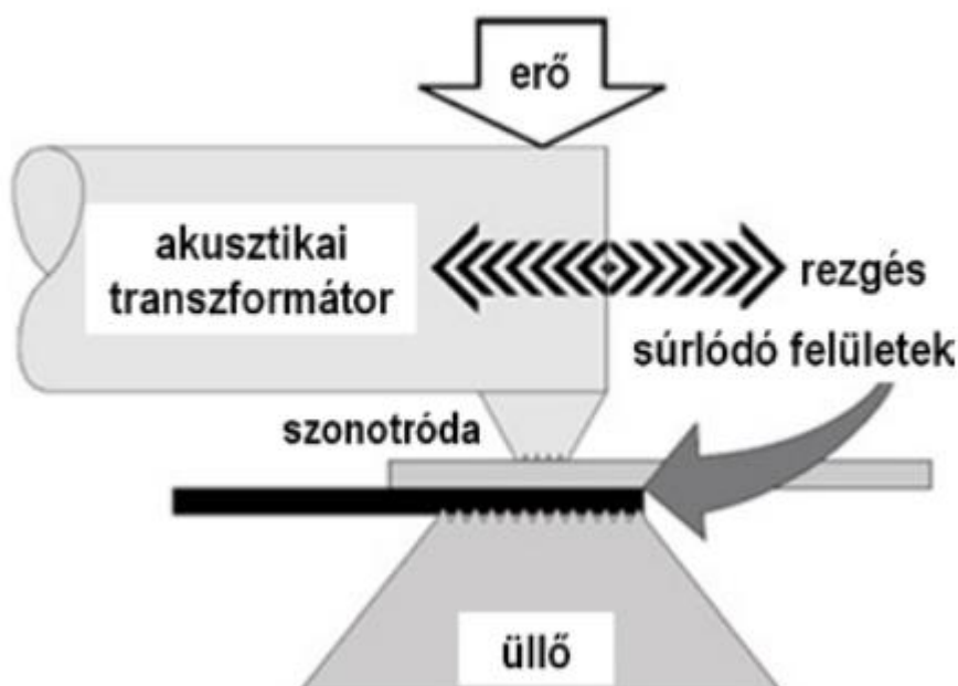
10. ábra Fém ultrahanghegesztés sematikus rajza [3 (31. o.)]
