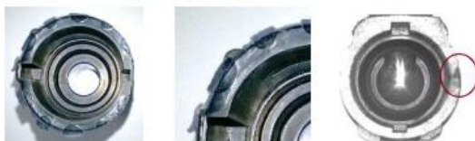
37. ábra Kamerás ellenőrzőállomás hibajelenségek
