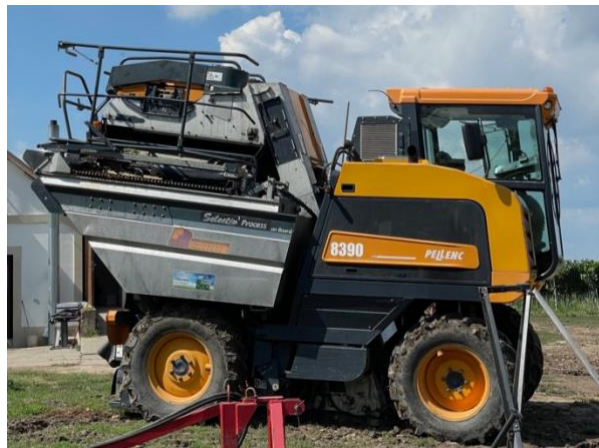
2. ábra. Pellenc 8390 önjáró szüretelő kombájn
