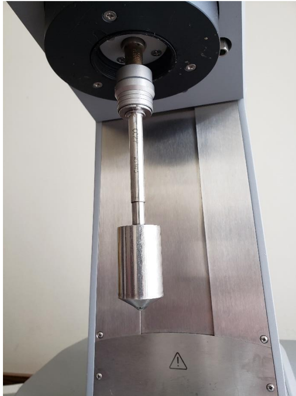
11. ábra – Az MCR51 mérőfeje
