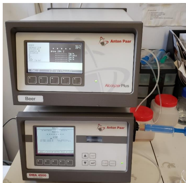
5. ábra – Anton Paar sőranalizátor és sűrűségmérő
