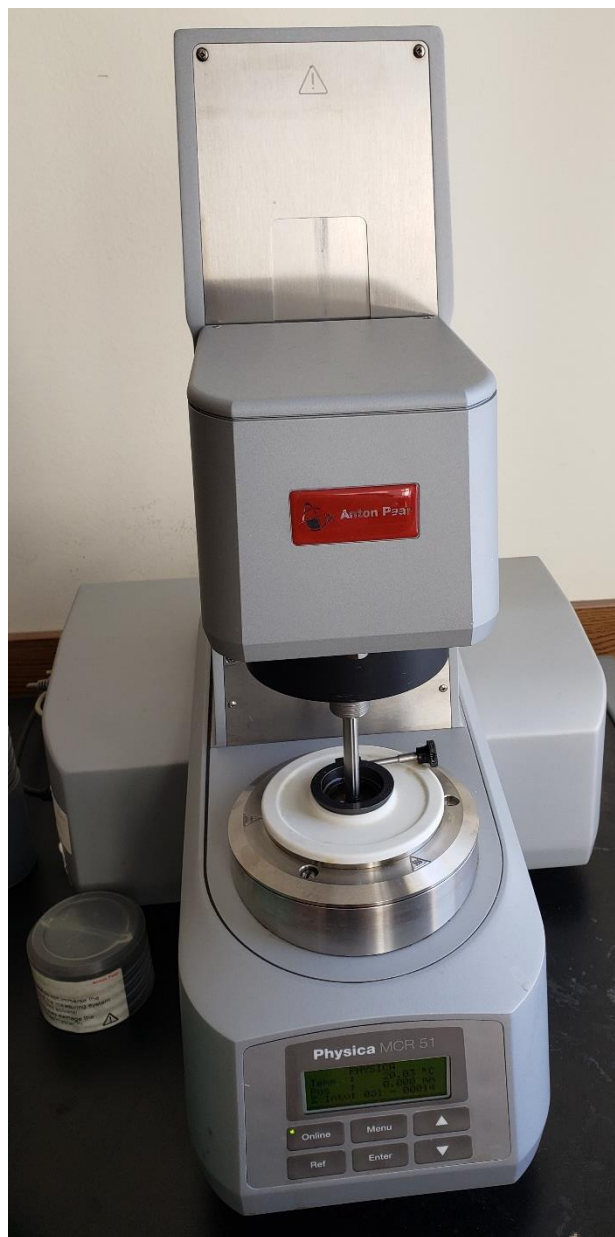
10. ábra – Anton Paar reométer mérés közben
