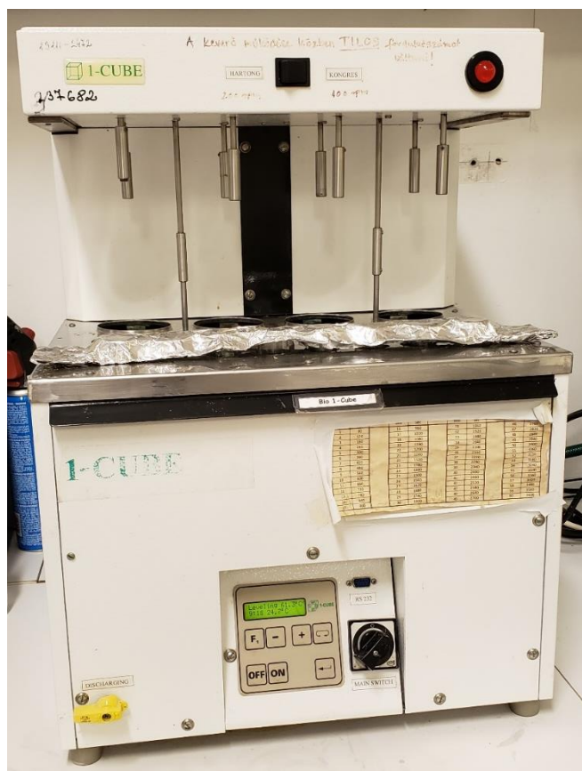
4. ábra – 1-Cube cefrésző berendezés
