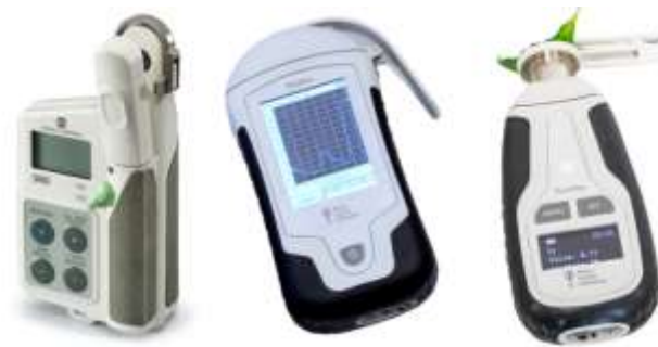
7. ábra: Gyors műszeres vizsgálatokhoz használt készülékek (balról: SPAD 502; PolyPen RP 410; FluorPen FP 110/D)
