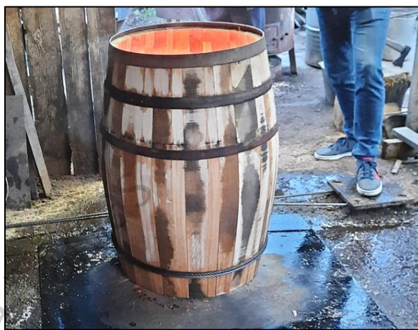
9. ábra. A hordóforma kialakítása, dongák hajlítása (ZHORELA, 2022)
