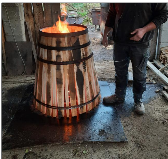
9. ábra. A hordóforma kialakítása, dongák hajlítása (ZHORELA, 2022)
