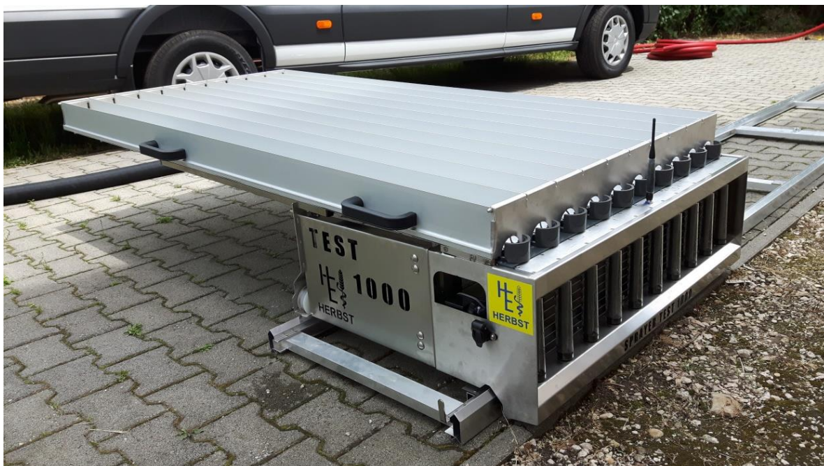
4. ábra: A Herbst Sprayertest 1000 vizsgáló berendezés működés közben (Forrás: Szóráskép Kft.)
