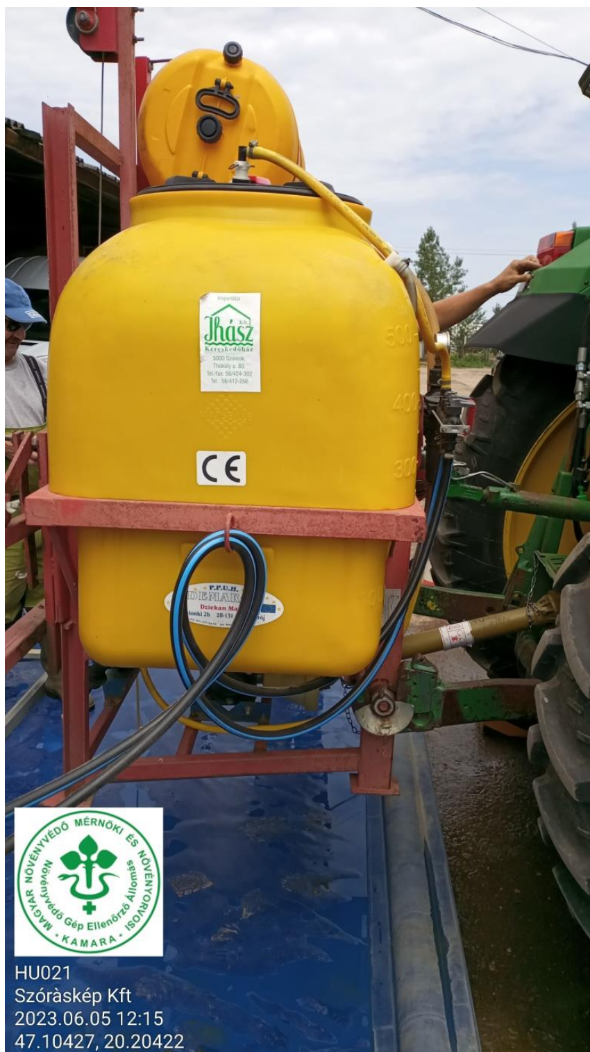
6. ábra: Demarol 600/13 típusú, függesztett szántóföldi permetezőgép műszaki vizsgán (Forrás: Szóráskép Kft.)
