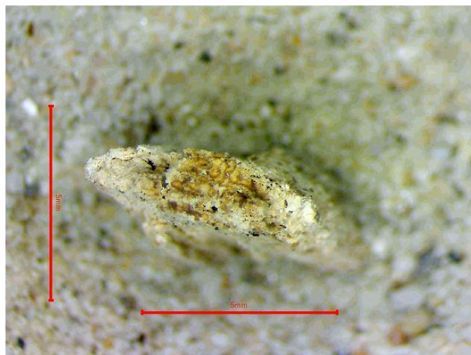
8. ábra: 6294-3 alminta keresztmetszeti képe, 10-szeres nagyításban
