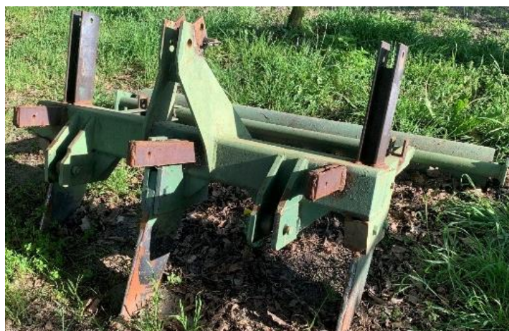
11. ábra: Saját gyártmányú függesztett gyepgazdálkodási eszköz 3 lazító késsel, sima lezáró hengerrel (Kiss Csanád, 2024)
