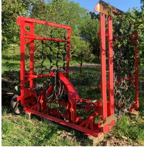
10. ábra: Lengyel gyártmányú láncos függesztett, hidraulikusan csukható rétbورونا (Kiss Csanád, 2024)
