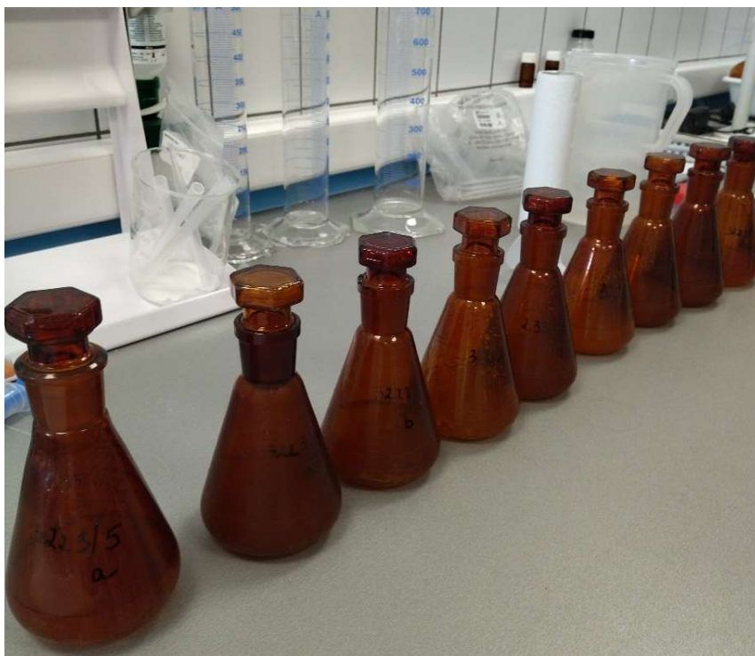
10. ábra: Bemért minták elhelyezése Erlenmeyer lombikokban
