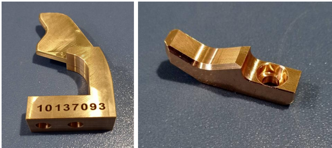
11. ábra: Havi rendszerességgel visszatérő kopó alkatrészek, réz megfogók [20]
