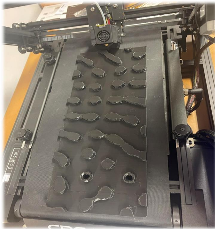
4.2.3.1. ábra A topológiai optimalizált lap nyomtatásának folyamata nyomtatás közben
