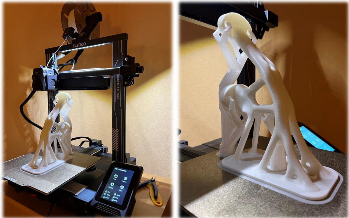
4.2.2.2. ábra A kinyomtatott generatív tartó
