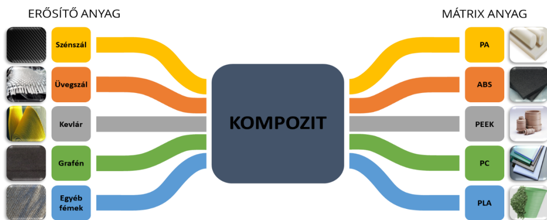
2.4.3.1. ábra 3D nyomtatásban alkalmazott erősítő és mátrix anyagok
