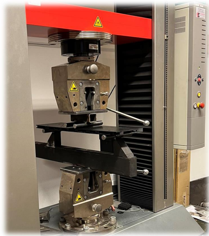
4.3.3.2. ábra A topológiai optimalizált lap mérési folyamata
