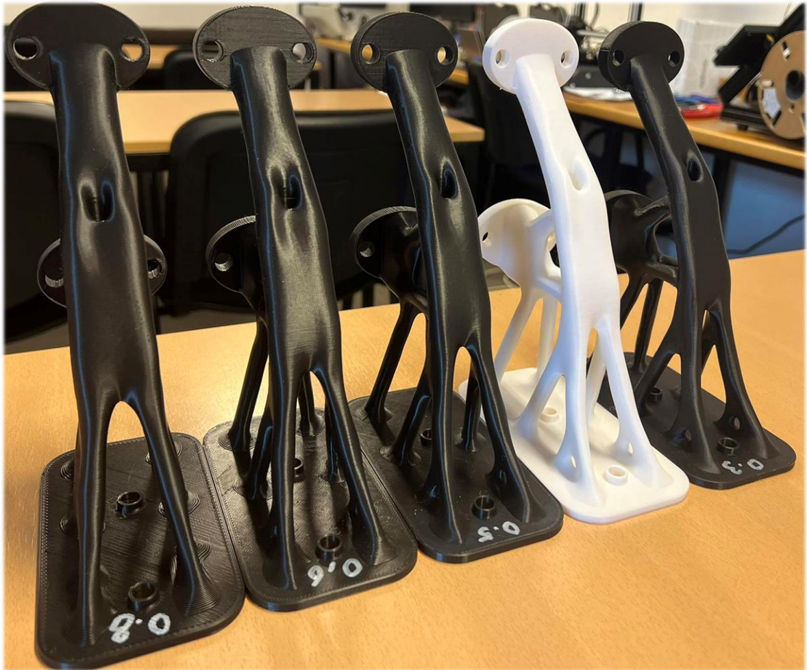
4.3.2.1. ábra Különböző fúvóka átmérőkkel nyomtatott próbatestek
