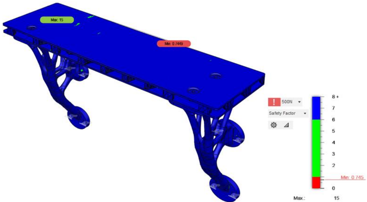
4.1.4.6. ábra A teljes szerkezet biztonsági tényező eloszlása
