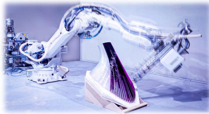
2.3.3.1. ábra 3D nyomtatásban alkalmazott robotkar (Kauppila, 2023)
