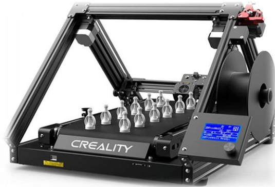
2.3.5.1. ábra Futószalagos FDM nyomtató kialakítása (O'Connell, 2022.)
