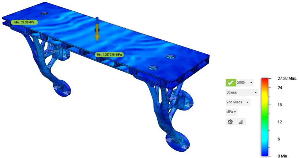
4.1.4.4. ábra A teljes szerkezet egyenértékű (von Mises) feszültségeloszlása
