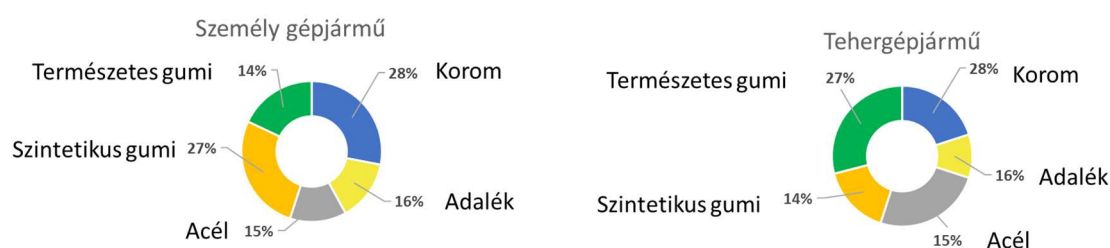
3. Ábra Személy és tehergépjármű gumiabroncsok összetétele
