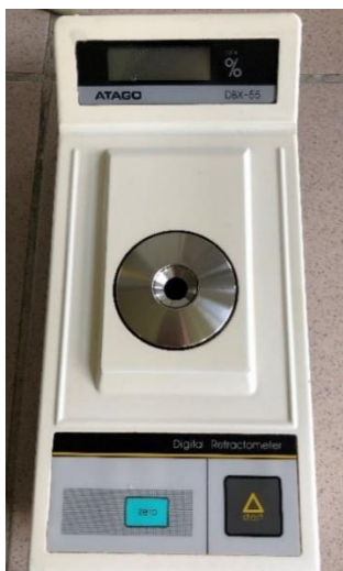
5. ábra ATAGO DBX-55 digitális refraktométer (saját kép)
