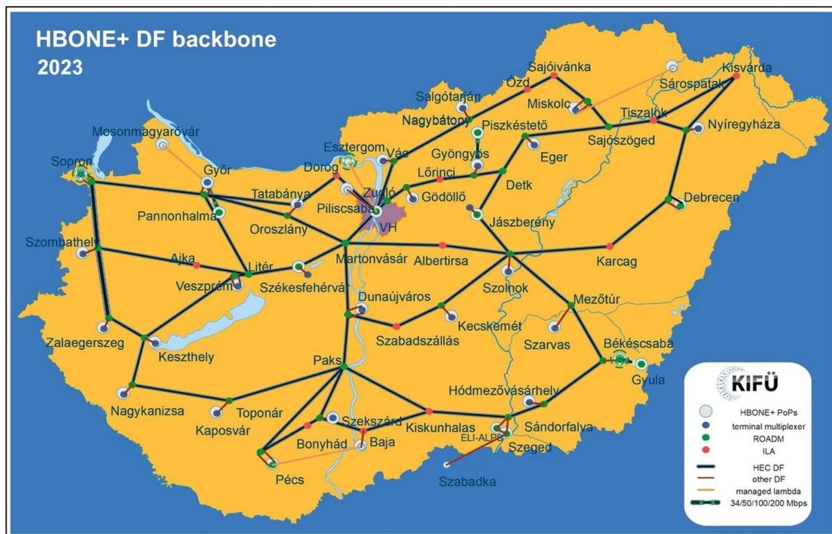
2. ábra: A HBONE+, az első magyarországi kormányzati gerinchálózat sémarajza
