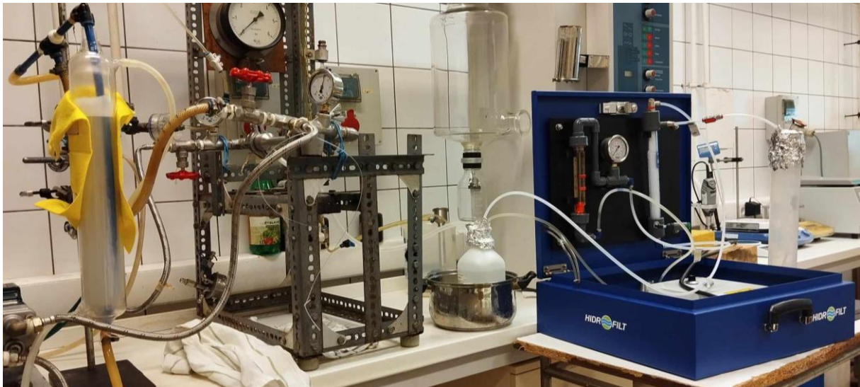
5. ábra: Kétlépcsős folyamatos UF-NF membránszűrő rendszer megvalósítása (Forrás: saját munka)
