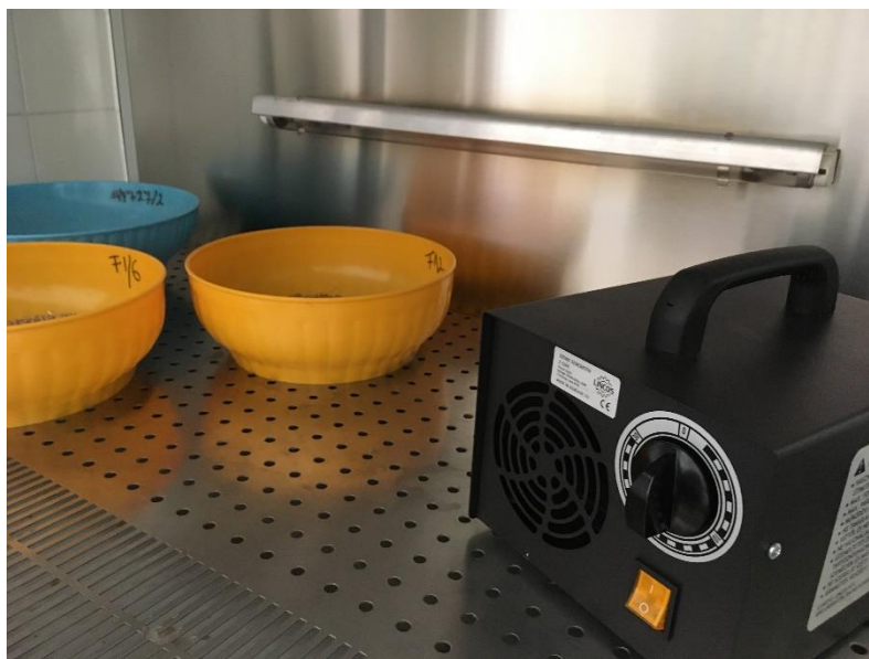
4. ábra Ózongenerátor és a kezelt minták
