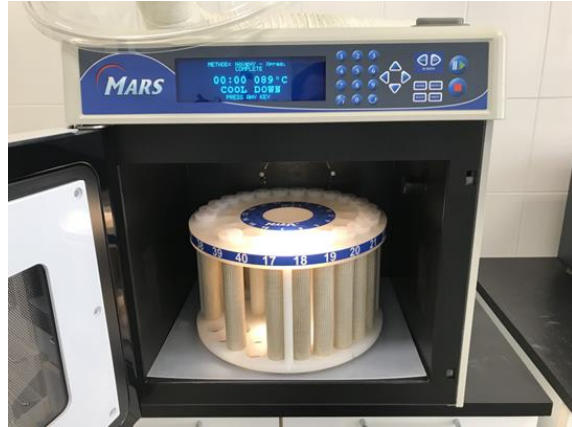
6.számú kép: Itt a CEM MARS 5 mikrohullámú roncsolót láthatjuk, benne a teflon bomba
