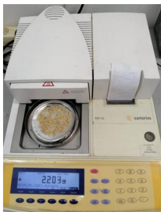
5. ábra: A behelyezett minta nedvességtartalom mérése
