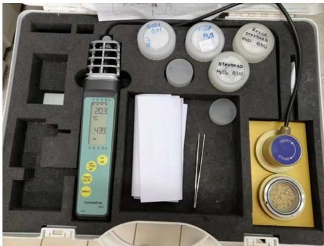
4. ábra: A dióminta vízaktivitás mérése
