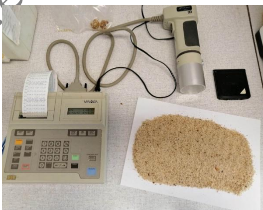
3. ábra: A dióminták színmérése Minolta Chromameter CR-310 készülékkel
