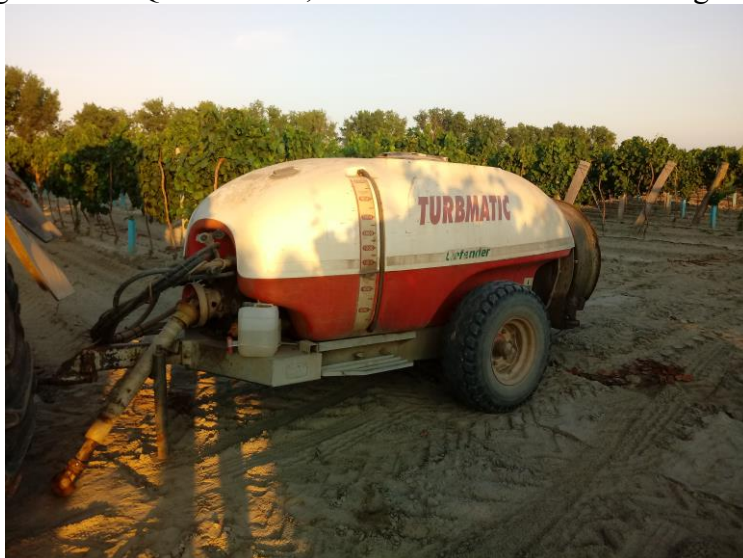
17. ábra Egytengelyű, vontatott, 2000 literes ventilátoros Permetezőgép (saját kép)
