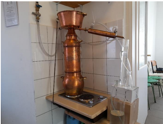
12. ábra: Orbáncfű hidrolátum készítése gőzlepárlással (Forrás: Saját felvétel, 2024. április 5.)
