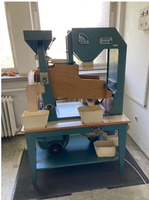
15. ábra: Kamas-Vestrup típusú rezgőtálcás magtisztító gép. Forrás: saját felvétel 2023.07.11.
