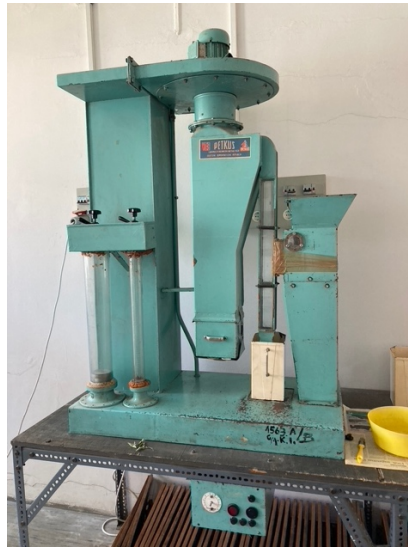
14. ábra: Levegő-befúvós magtisztító gép Forrás: saját felvétel 2023. 07.11.
